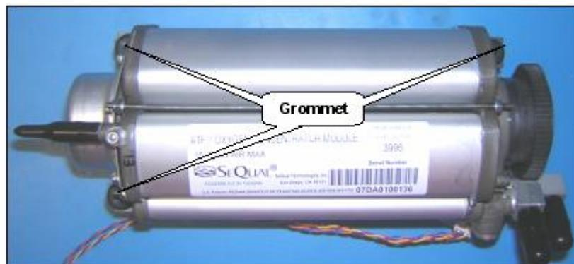
**Figure 33: ATF Module Grommet Installation.**
